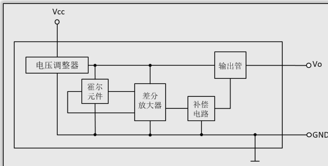
AH49E 霍尔传感器是一款模拟信号输出的霍尔集成电路，输出电压随着磁场强弱而变化。传感器芯片内置有反向电压保护器、电压调整器、温度补偿电路、霍尔电压发生器、信号放大器等电路单元。性能优良的电压调整器和温度补偿电路，确保传感器在较宽的电压范围和温度范围内稳定地工作，反向电压保护电路避免了传感器受到反向电压的损伤。
